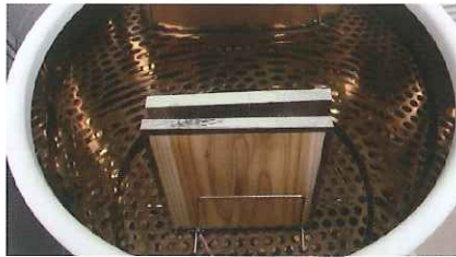
試験機関: (株)ダイヤ分析センター 試験方法: JIS A 1901 (小型チャンバー法)
