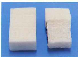
断熱材への影響を実験。 左がペネザープに浸漬した もの、右の変形している方は 『油溶剤』という油ベースの 薬剤に浸漬させたものです。
